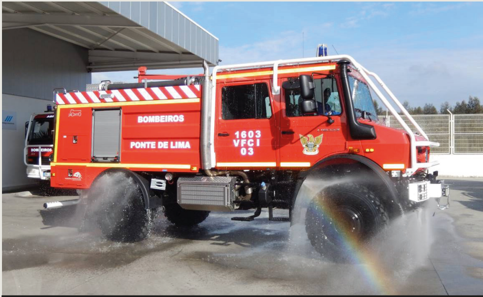
Das Waldbrand-TLF soll mit einer Selbstschutzanlage ausgestattet sein – hier ein Beispiel aus Portugal. (Foto: R. Maile/Feuerwehr Stuttgart)
