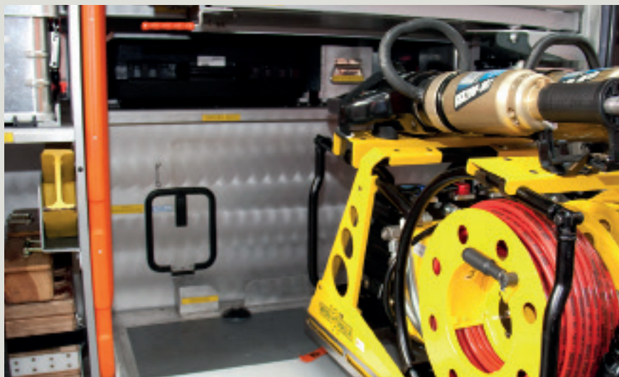
Einfüllstutzen hinter eingebautem Gerät: Hier ist besondere Vorsicht beim Einfüllen der kriechfähigen Flüssigkeit nötig. (Foto: G. Fenchel)
